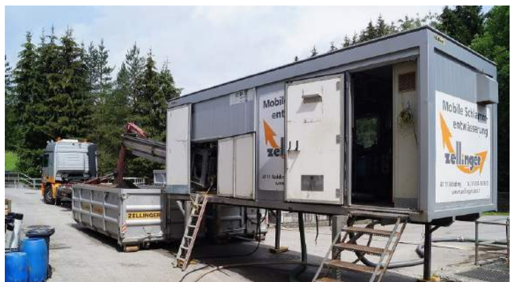
Die mobile Presse zur Entwässerung des Klärschlammes ist der 1. Schritt in der immer längeren Verwertungs- bzw. Entsorgungskette nach der davor schon aufwändigen Abwasserreinigung. Sauberes Trinkwasser und gereinigtes Abwasser haben eben ihren immer höher werdenden Preis.
