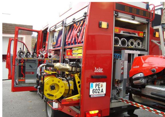
Das Fahrzeug ist vollgepackt mit modernstem Gerät, u. a. mit Bergeschere, Notstromaggregat und Flutlichtmast.
