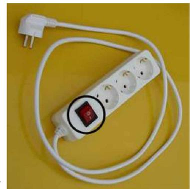
Foto rechts: Steckerleiste mit Hauptschalter
